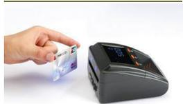
In caso di banconota sospetta il verificatore emette un segnale acustico e visualizza sul display il tipo di errore. Effettua un controllo di dimensione della banconota, ultravioletti, inchiostro magnetico, presenza del filo e infrarossi.
